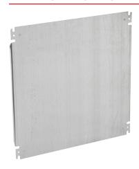
Panneaux à commander séparément. Les panneaux de montage se composent de tôles d'acier conductrices d'une épaisseur de 2 mm. Montage avec vis à gorge M8×1,25. Éléments de fixation fournis dans le kit de montage pour coffret GL66.
