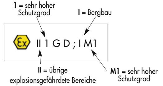
Einsatz : mit Grubengas gefüllte Minen und explosionsgefährdete Bereiche der Gruppen IIC, IIB und IIA in Temperaturklasse T4 und/oder brennbarem Staub (T135°C).
