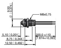
SOLDER LUG/FASTON 9,50 0,374 ] M8x0,75 2,8x0,8[0,11x0,031] 5,10 [ 0,201 ] 10,00 [ 0,394 ] 9,35 [ 0,368 ] <u>8,75 [ 0,344</u> 28,75 [ 1,132] PINS 9,50 0,374] 0,020 ,25 [ 0,049 ] 25 [ 0,049] M8x0,75 50 6 5,10 [ 0,201 ] 8,00 [ 0,315 ] 8,75 [ 0,344 6,50 [ 0,256 ] 22,50 [ 0,886 REAR EPOXY PINS 9,50 0,374 ] 0,020 0.049 0.049 M8x0,75 20 25 6 5,10 [ 0,201 ] 20,88 [ 0,822 ] 8,75 [ 0,344 19,38 [ 0,763 ] 10,50 [ 0,413 ] SHORT BODY PINS
