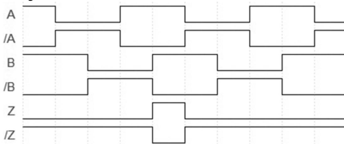
Drehung im Uhrzeigersinn (Sicht auf Welle)
