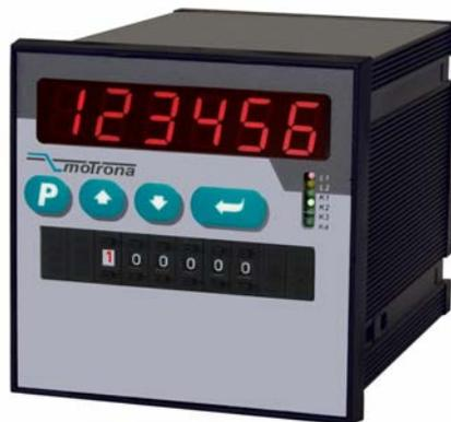
Verstellung des Drehzahlverhältnisses über die frontseitigen Dekadenschalter des BY641
